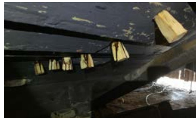
Bordene på en nordlandsbåt er satt fast i bandene med trenagler. De gamle måtte bores forsiktig ut, og nye settes inn når bandet var på plass
