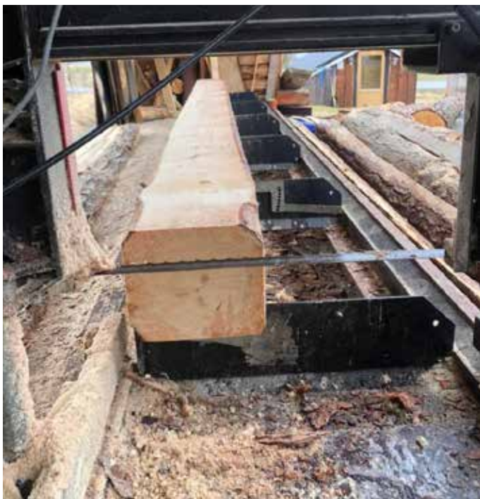
Detalj fra Sveins båndsag av typen Johnsered. Her er det mulig å skjære virkelig fint virke! Stokken ligger i ro på benken, mens saga triller på skinner
