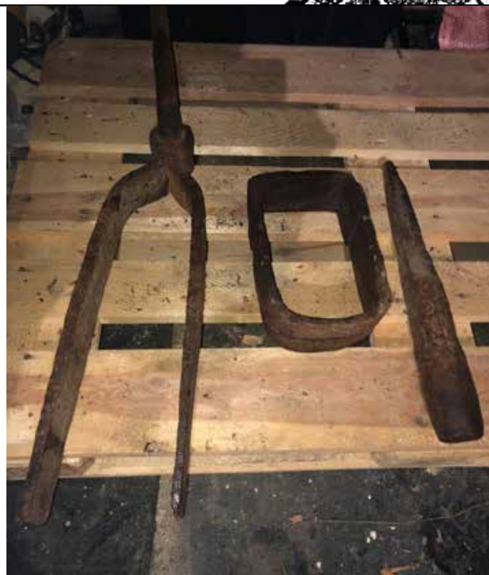
Noen av de andre beslagene som Svein har tatt vare på fra oppgangssaga. Sannsynligvis smidd av sagføreren sjøl.
