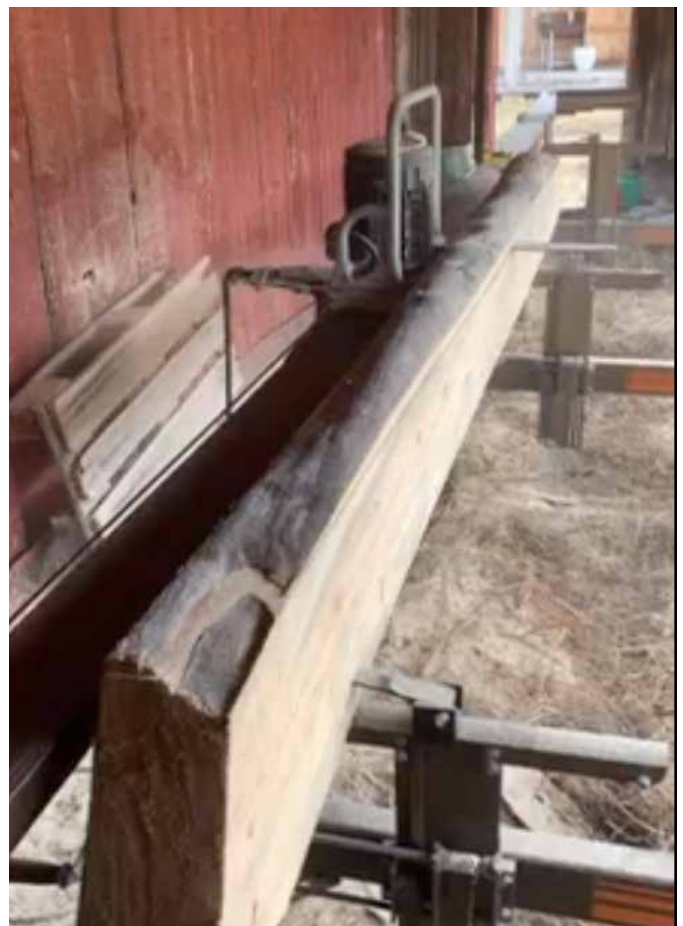
Stornaustsaga av typen Logosol. Stokken spennes fast i benken, og en elektromotor drar den elektriske kjedesaga frem under saginga.
