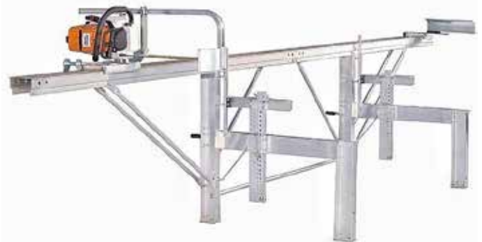
Logosol sine sagbenker er fleksible og enkle. Her er Alf Bjarnes modell med motorsag. På Stornaussaga er saga drevet av el trefaset elmotor med elektrisk fremtrekk.
